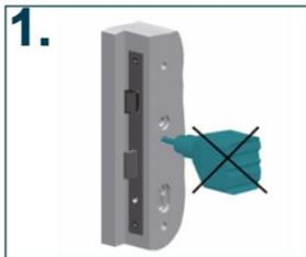
Das Türblatt darf im Schlossbereich nicht bei eingebautem Schloss durchbohrt werden.
